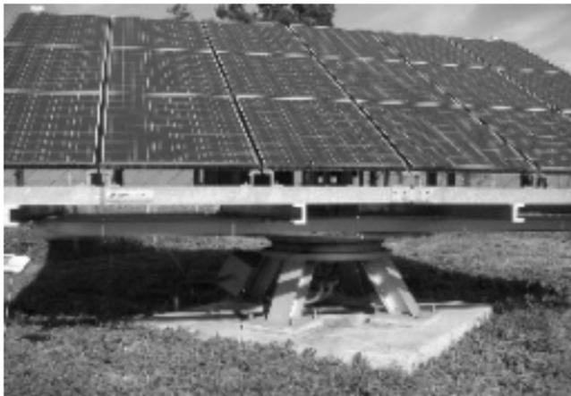
上の写真は、GPS（人工衛星追尾）機能によって、太陽光を最も効率的に受光できる角度と報告を自動的に計算して動く実験機械です。
